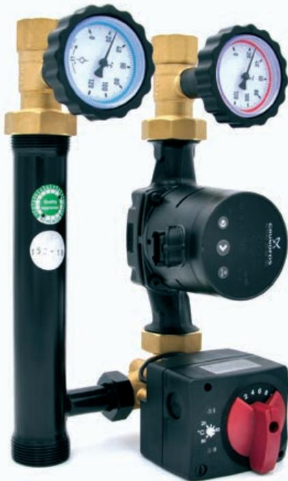
Die komplett vormontierten Pumpengruppen für den gemischten Heizkreis mit konstanter Vorlauftemperatur sind mit Hocheffizienzpumpen der Baulänge 180 mm inklusive Stromversorgungskabel, Kugelhähnen auf Vor- und Rücklaufseite mit Thermometergriff (mit Rückflussverhinderer 20 mbar im Rücklauf), und einem drei Wege Mischventil mit stufenlos einstellbarem Bypass ausgestattet. Vor- und Rück ist tauschbar.
