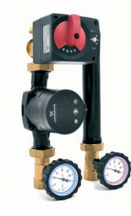
Die komplett vormontierten Pumpengruppen für den gemischten Heizkreis mit konstanter Vorlauftemperatur sind mit Hocheffizienzpumpen der Baulänge 180 mm inklusive Stromversorgungskabel, Kugelhähnen auf Vor- und Rücklaufseite mit Thermometergriff (mit Rückflussverhinderer 20 mbar im Rücklauf), und einem Festwertregler auf drei Wege Mischventil mit stufenlos einstellbaren Bypass ausgestattet. Vor- und Rücklauf ist tauschbar.
