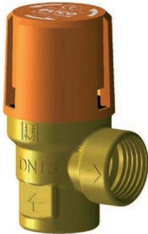
Die Solar-Sicherheitsventile dienen dem Schutz von Solaranlagen gegen Überdruck. Der eingestellte Druck (Bar) sowie die maximale Leistung des Ventils sind auf den Ventilen angegeben. Die auf dem Ventil angegebene Leistung muss größer sein als die Leistung des Wärmeerzeugers. Alle Ventile erfüllen die Anforderungen der Druckgeräterichtlinie 2014/68/EU Modul B und D.
