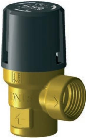
Die Sicherheitsventile dienen dem Schutz von Heizungs- und Kühlsystemen gegen Überdruck. Der eingestellte Druck (Bar) sowie die maximale Leistung des Ventils sind auf den Ventilen angegeben. Die auf dem Ventil angegebene Leistung muss größer sein als die Leistung des Wärmeerzeugers. Alle Ventile erfüllen die Anforderungen der Druckgeräterichtlinie 2014/68/EU Modul B und D.
