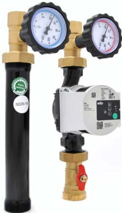
Die komplett vormontierten Pumpengruppen für den direkten Heizkreis sind mit Hocheffizienzpumpen der Baulänge 180 mm inklusive Stromversorgungskabel, Kugelhähnen auf Vor- und Rücklaufseite mit Thermometergriff (mit Rückflussverhinderer 20 mbar im Rücklauf) und einem weiteren Pumpenkugelhahn im Vorlauf mit Knebelgriff ausgestattet. Vor- und Rücklauf ist tauschbar.
