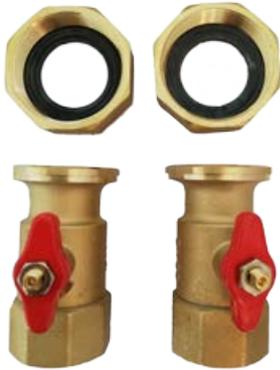
Das Anschlussset besteht aus je zwei Pumpenkugelhähnen mit Knebelgriff und zwei Überwurfmutter mit EPDM Dichtung und dient dem mühelosen Einbau der Pumpengruppen direkt ins Rohrsystem. Die Dichtfläche zwischen Anschlussset und Pumpengruppe ist flachdichtend. Durch den Einsatz von Absperrkugelhähnen lassen sich Vor- und Rücklaufseite der Pumpengruppen komplett absperren und erleichtern somit den Austausch oder die Wartung einzelner Komponenten.
