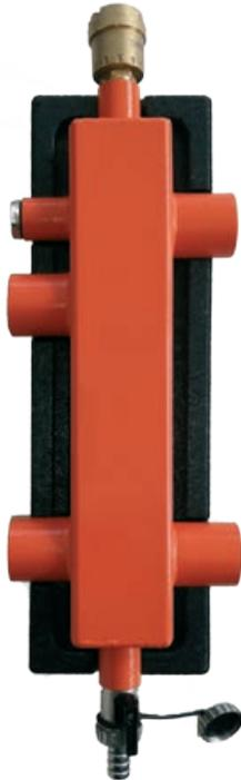
Die hydraulische Weiche dient der hydraulischen Entkopplung von Heizungs- und Rücklauf. Dies ist insbesondere beim Einsatz mehrerer Heizkreise notwendig, da in den Heizkreisen durch die unterschiedliche Pumpenleistung unterschiedliche Drücke herrschen. Die Hydraulische Weiche wird inklusive der Isolierung geliefert. Der Lieferumfang umfasst zudem 1x Entlüftungsventil, 1x Entleerhahn und eine Anschlussmuffe (verschlossen) für den Einsatz eines Tauchfühlers.
