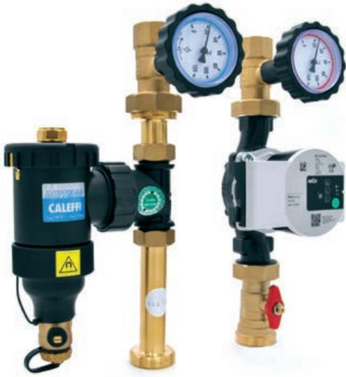
Die komplett vormontierten Pumpengruppen für den direkten Heizkreis mit integrierten Magnetit Abscheider ist mit Hocheffizienzpumpen der Baulänge 180 mm inklusive Stromversorgungskabel, Kugelhähnen auf Vor- und Rücklauf-seite mit Thermometergriff (mit Rückflussverhinderer 20 mbar im Rücklauf), und einem weiten Pumpenkugelhahn mit Knebelgriff im Vorlauf ausgestattet. Vor- und Rücklauf ist tauschbar.
