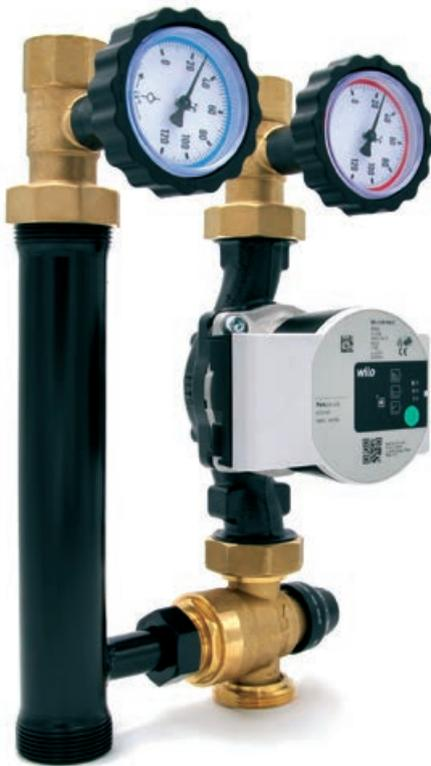
Die komplett vormontierten Pumpengruppen für den gemischten Heizkreis mit konstanter Vorlauftemperatur sind mit Hocheffizienzpumpen der Baulänge 180 mm inklusive Stromversorgungskabel, Kugelhähnen auf Vor- und Rücklaufseite mit Thermometergriff (mit Rückflussverhinderer 20 mbar im Rücklauf), und einem thermostatischen drei Wege Mischventil ausgestattet. Vor- und Rücklauf ist tauschbar.
