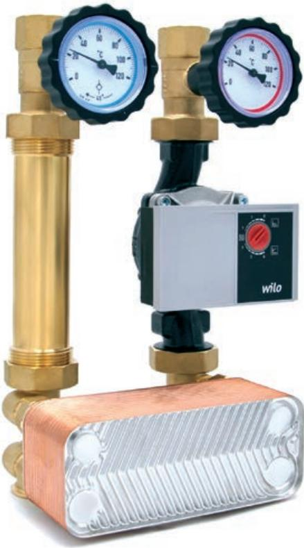
Die komplett vormontierten Pumpengruppen für den Einsatz als Trennsystem zum Trennen von zwei Zirkulationskreisen zum Beispiel in Solaranlagen sind mit Hocheffizienzpumpen der Baulänge 180 mm inklusive Stromversorgungskabel, Kugelhähnen auf Vor- und Rücklaufseite mit Thermometergriff (mit Rückflussverhinderer 20mbar im Rücklauf) und einem Kupfer Plattenwärmetauscher ausgestattet. Vor und Rücklauf ist tauschbar.
