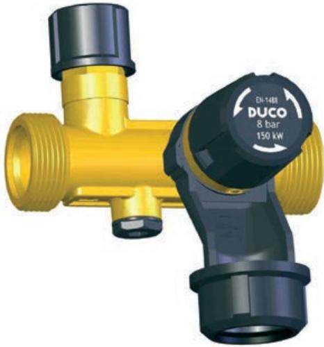
Die Zulaufkombination erfüllt mehrere Zwecke. Sie dient der Wasserversorgung des Warmwassererzeugers, der Absperrung der Versorgungsleitung, schützt den Warmwasserbereiter vor Überdruck und verhindert mittels Rückschlagventil, dass heißes Wasser in die Kaltwasserzuleitung zurückfließt. Das Ventil hat die KiWA Zulassung und entspricht der Norm EN 1488
