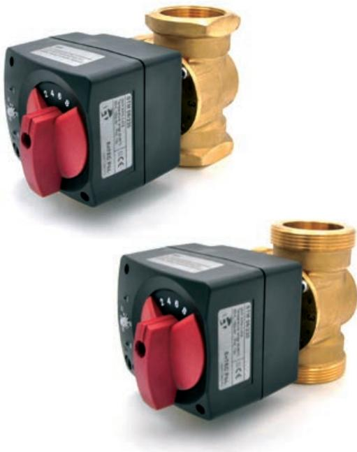
Das Heizkreiskonstanttemperaturset besteht aus einem 3 Wege Ventil und einem passenden Regelmotor mit 6Nm. Mit dem Set lässt sich ein konstant geregelter gemischter Heizkreislauf aufbauen (mittels Temperatursensor). NTC-Fühler mit 1m Kabel, +20 bis +80°C
