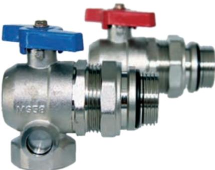
Zum einfachen Anschluss an das Heizsystem stehen für die vertikale Installation Anschlusskugelhähne mit blauen bzw. roten Flügelgriff zur Verfügung. Die Montage am Verteiler ist selbstdichtend-
