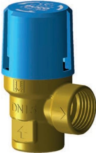
Die Sicherheitsventile dienen dem Schutz von geschlossenen Trinkwassersystemen gegen Überdruck und können in jedem Trinkwasserspeichersystem eingesetzt werden. Der eingestellte Druck (Bar) sowie die maximale Leistung des Ventils sind auf den Ventilen angegeben. Die auf dem Ventil angegebene Leistung muss größer sein als die Leistung des Wärmeerzeugers. Alle Ventile sind KiWA zertifiziert und erfüllen die Anforderungen der Druckgeräterichtlinie 2014/68/EU Modul B und D.
