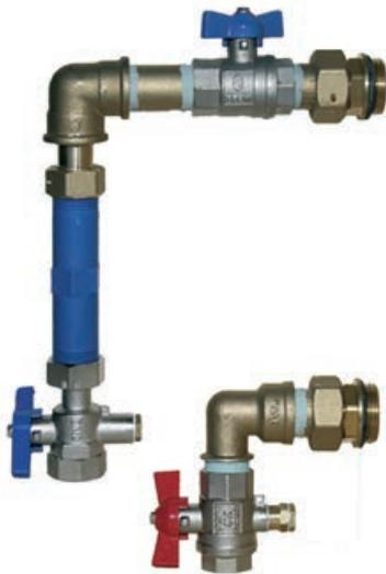
Zum einfachen Anschluss an das Heizsystem mit Vorrüstung für einen Wärmemengenzähler mit Direktfühlermessung steht für die horizontale Installation ein Anschlusset mit 1 Vorlaufkugelhahn mit Direktfühleranschluss und ein Winkel sowie zwei Rücklaufkugelhähne (1x Anschluss Verteiler, 1x Anschluss Heizsystem mit Direktfühleranschluss), ein Winkel und ein Kunststoffdistanzrohr mit 110 mm Baulänge zur Verfügung. Die Montage am Verteiler ist selbstdichtend-
