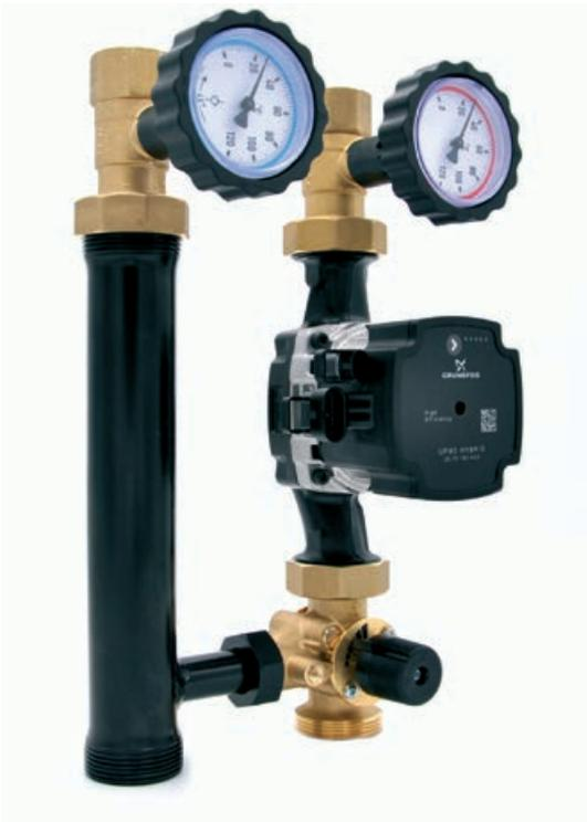
Die komplett vormontierten Pumpengruppen für den gemischten Heizkreis sind mit Hocheffizienzpumpen der Baulänge 180 mm inklusive Stromversorgungskabel, Kugelhähnen auf Vor- und Rücklaufseite mit Thermometergriff (mit Rückflussverhinderer 20 mbar im Rücklauf) und einem drei Wege Mischventil mit stufenlos einstellbaren Bypass ausgestattet. Vor- und Rücklauf ist tauschbar.
