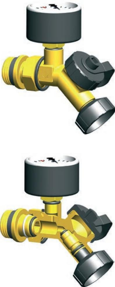
Sinkender Wasserdruck macht das Nachfüllen von Heizungswasser in das Heizungssystem notwendig. Dies kann mit einer Schlauchverbindung in Kombination mit einer Füllgruppe geschehen. Die Wivak Füllgruppe ist serienmäßig mit einem Manometer versehen (4bar) und einem ½" Endstück mit Dichtung. Zudem hat sie eine Hahn/Ventil (Spindeldichtung) mit Verschlusskappe und Kunststoffschlauchtülle mit Drehgelenk, so dass der Befüllschlauch flexibel angeschlossen werden kann.
