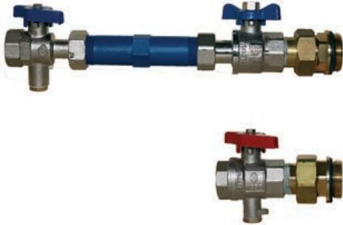
Zum einfachen Anschluss an das Heizsystem mit Vorrüstung für einen Wärmemengenzähler mit Direktfühlermessung steht für die horizontale Installation ein Anschlusset mit 1 Vorlaufkugelhahn mit Direktfühleranschluss sowie zwei Rücklaufkugelhähne (1x Anschluss Verteiler, 1x Anschluss Heizsystem mit Direktfühleranschluss) sowie ein Kunststoffdistanzrohr mit 110 mm Baulänge zur Verfügung. Die Montage am Verteiler ist selbstdichtend-
