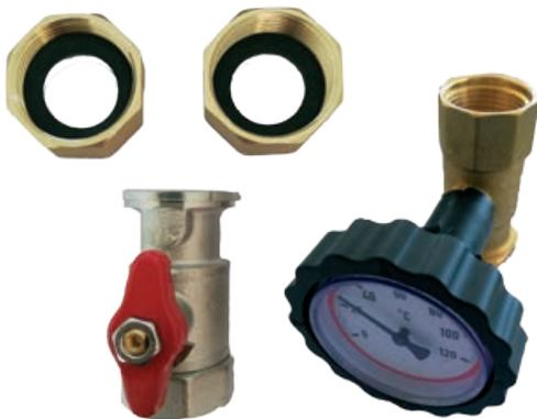
Das Absperrset besteht aus je einem Absperrkugelhahn mit Thermometergriff (Rot) mit Pumpenflansch und einem Absperrkugelhahn mit Knebelgriff mit Pumpenflansch sowie je zwei Überwurfmutter mit EPDM Dichtung und dient dem mühelosen Einbau einer Heizungsumwälzpumpe in das Rohrleitungssystem. Die Absperrung vor und hinter der Pumpe ermöglicht die einfache Wartung bzw. den Tausch der Heizungspumpe.
